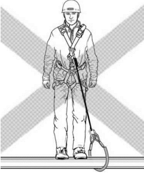
Şekil Q.2 – Bir istasyon sapanını normal asılma pozisyonundan kaldırarak potansiyel düşme mesafesini artırmak
